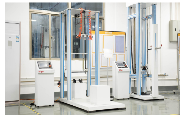
フレーム垂直荷重試験
